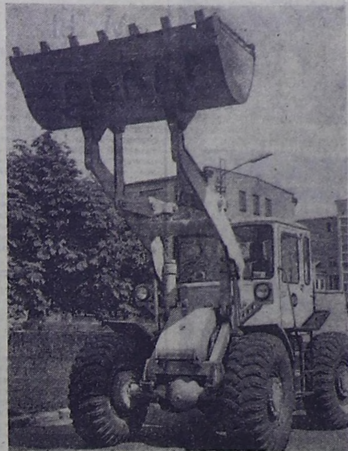
Министерство универсальной одноконвойной погрузчик ТО-18 — универсальная машина, предназначенная для погрузки сыпучих материалов, планировки строительных площадок, перемещения грунта. Погрузчик может использоваться также на монтажных и такелажных работах.
